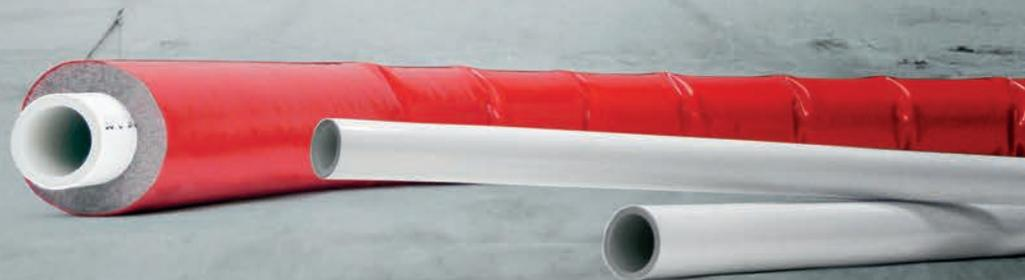
Das Pipetec Aluminium-Mehrschichtverbundrohr ist ein fünf-schichtiges Kunststoff-Metall-Verbundrohr **für Sanitär- und Heizungsanwendungen**. Es hält einer Dauertemperatur von 70 °C und einem Maximaldruck von 10 bar über 50 Jahre stand. Die zulässige maximale Betriebstemperatur beträgt 95°C für max. ein Jahr.
