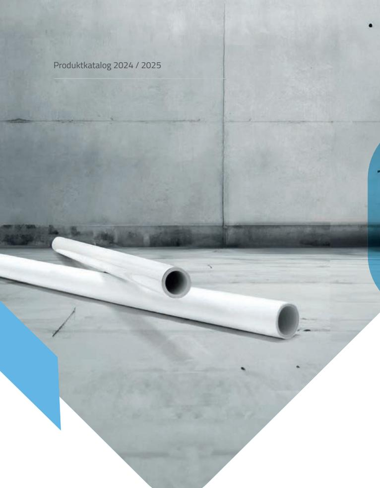
Das Pipetec Aluminium-Mehrschichtverbundrohr ist ein fünfschichtiges Kunststoff-Metall-Verbundrohr für **Heizungsanwendungen** und hält einer Dauertemperatur von 60 °C und einem Maximaldruck von 6 bar über 50 Jahre stand. Die zulässige maximale Betriebstemperatur beträgt 80°C für max. 1 Jahr.
